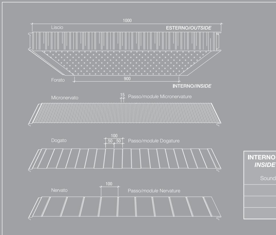
I valori delle luci ammissibili riportati in tabella sono il risultato di prove pratiche eseguite presso i nostri stabilimenti e garantiscono contemporaneamente una freccia  $f \leq L/200$  e un coefficiente di sicurezza 2,5 rispetto al carico di rottura. I valori della trasmittanza fanno riferimento a una temperatura ambientale oscillante tra i 10°C e i 50°C.
