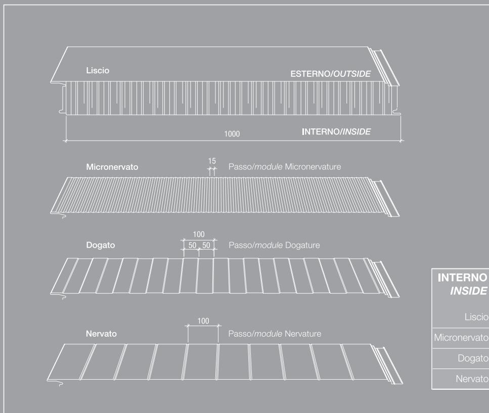
I valori delle luci ammissibili riportati in tabella sono il risultato di prove pratiche eseguite presso i nostri stabilimenti elaborate con il metodo di STAMM-WITTE applicando un coefficiente di sicurezza 2,5 rispetto al carico di rottura e garantendo contemporaneamente una freccia  $f \leq L/200$ .
