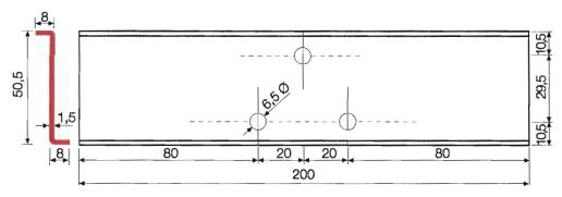
Material: Stahlblech S 320 GD+AZ185 nach DIN EN 10346, t = 1,5 mm
