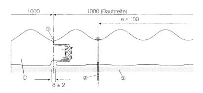
Parallel zur Spannrichtung: Stützweitenabstand am Tafelende e<sub>R</sub> ≥ 20mm und ≥ 3d
