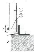
**Bild 4** Fußpunkt Wandelement aufgesetzt
