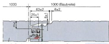
Bei Befestigung mit 2 Schrauben pro Punkt, Abstand der Schrauben ≥ 40 mm
