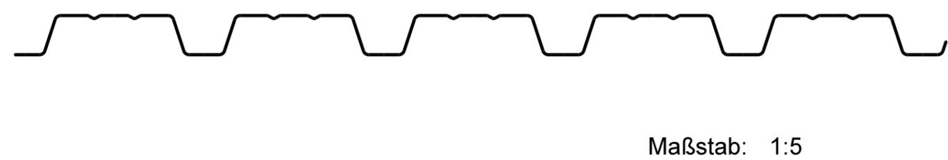
Bemaßung und Toleranzen nach DIN 18807 Teil 1 bzw EPAQ bei max. Blechdicke von 1,5 mm
